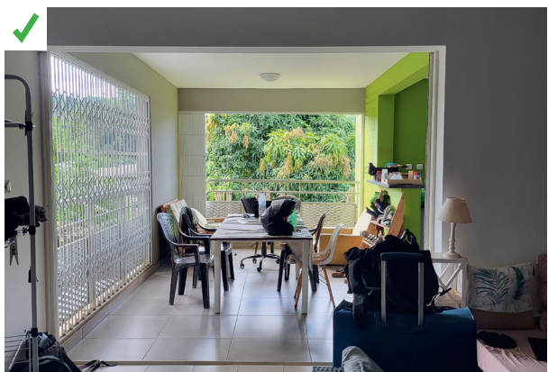
La surface de mur en béton banché exposée au soleil est faible et de grandes ouvertures sont présentes. La ventilation naturelle permet l'évacuation de l'air chaud vers l'extérieur. ©AQC
