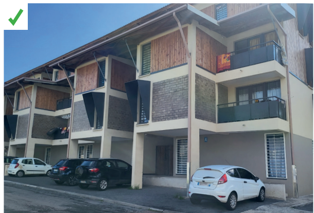
Les façades sont protégées des rayonnements solaires directs, grâce aux décrochés, auvents et terrasses. ©AQC
