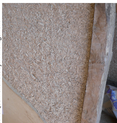
3) Un béton biosourcé picard : « l'isolibois » fabriqué à partir de déchets de bois et de lin, recouvert en partie de l'enduit extérieur « le plafond picard ».
