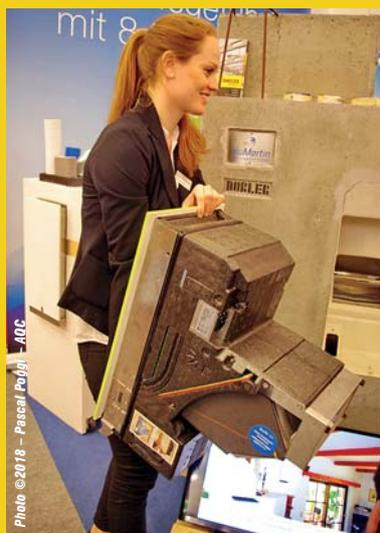
▲ Le double flux décentralisé FreeAir 100 de bluMartin est équipé de 6 sondes de température, de CO<sub>2</sub> et d'hygrométrie. Il est certifié par le Passivhaus Institut avec un taux de récupération de chaleur de 87 %.
