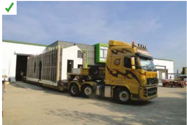
En sortie d'atelier, les modules sont acheminés sur le chantier en convoi exceptionnel, suivant l'itinéraire autorisé par l'administration. ©AQC
