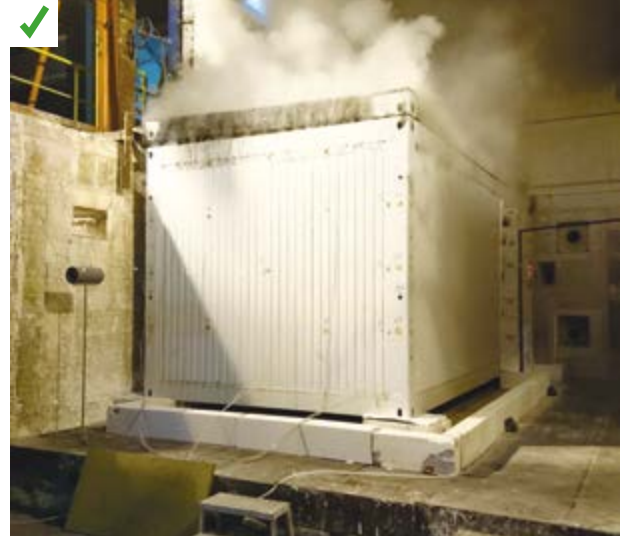
Exemple d'essai de comportement au feu pour justifier de la résistance au feu d'un module à structure métallique. La phase d'essai doit être programmée et anticipée. @EFFECTISFrance
