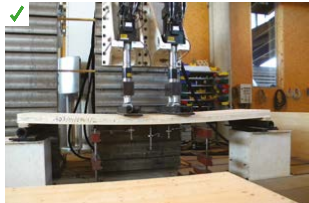
Exemple d'essai de flexion 4 points sur CLT (structure bois lamellé contrecroisé). La phase de justification doit être prévue en amont du projet. ©FCBA
