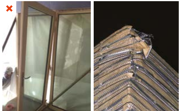
Gauche : arrachement du châssis suite à l'ouverture intempestive du vantail lors du transport. ©Selvea Droite : angle abîmé lors du transport. ©AQC
