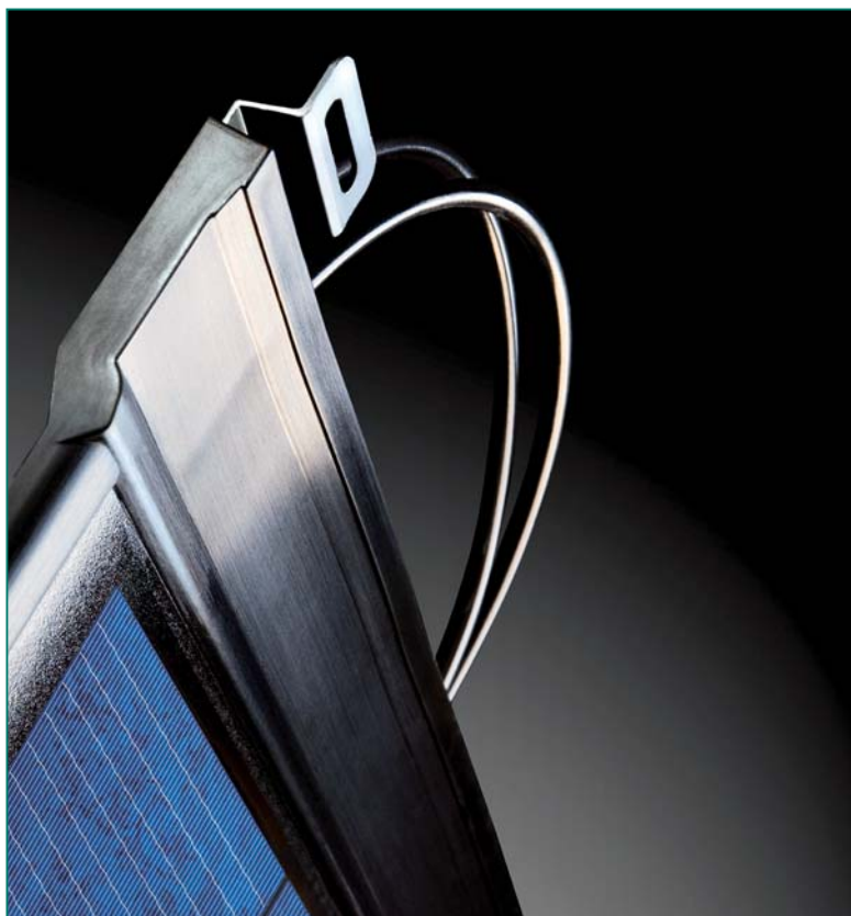
Photo Koramic : La connectique et les fixations intégrées dans le cadre du module KoraSun facilitent la mise en œuvre et augmentent la longévité du système.
