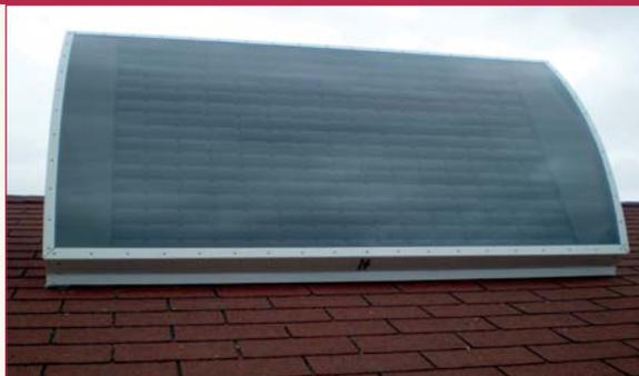
Photo Cansolair : Capteur canadien avec vitrage courbe en polycarbonate et absorbeur composé d'un assemblage de canettes en aluminium.
