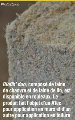
*Biofib' duo*, composé de laine de chanvre et de laine de lin, est disponible en rouleaux. Le produit fait l'objet d'un ATec pour application en murs et d'un autre pour application en toiture
