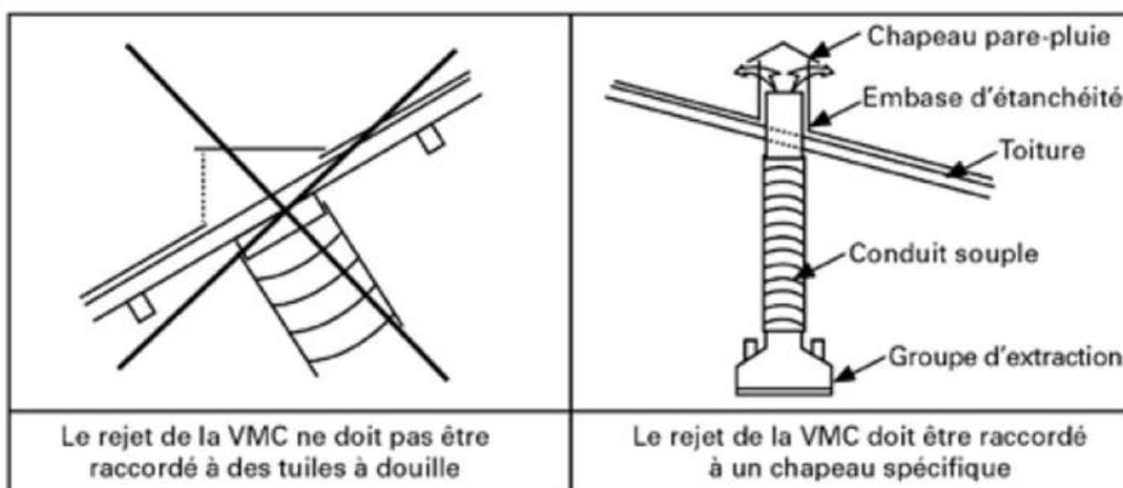
Raccordement du refoulement de la VMC
